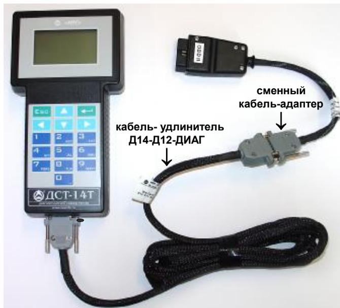
Рис. 2. Подключение кабелей к сканеру тестеру
